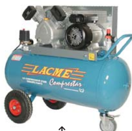
COMPRESTAIR 100 (Mono.) 100 l - 17 m 3 /h - 11 bar - Groupe fonte bicylindre en V - Moteur 3 CV mono. - Sortie directe (racc. rapide) et un épurateur détendeur petit modèle.
