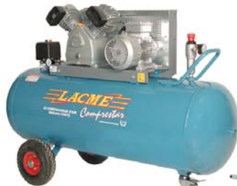
COMPRESTAIR 200 (Tri.) 200 l - 27 m 3 /h - 11 bar - Groupe fonte bicylindre en V - Moteur 4 CV tri. - Sortie directe (racc. rapide) 1 épurateur détendeur grand
